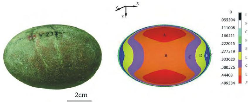
插图 1 金剛口椭圆形蛋(V732)及等效应力分布云图(单位:MPa)
