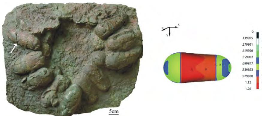
插图 2 瑶屯巨型蛋(V2784)及等效应力分布云图(单位:MPa, 箭头所示为测量样品)
