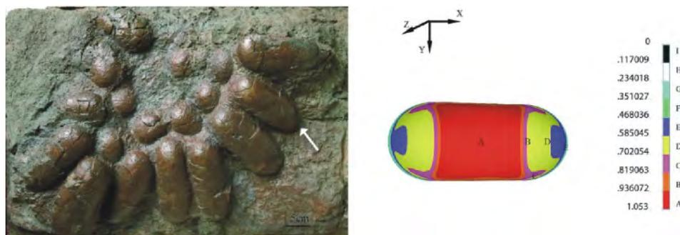
插图 3 粗皮巨型蛋(V2788)及等效应力分布云图(单位:MPa; 箭头所示为测量样品)
